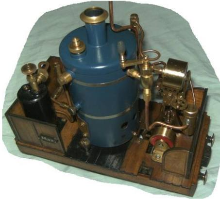
Sur la « Microloc Regner » : ajout d'un régulateur à levier et d'un graisseur à déplacement (modifié à partir d'un graisseur MAMOD peu performant) dont la sortie de vapeur est branchée à l'entrée d'origine. Le petit graisseur d'origine est inutilisé et le robinet d'origine est ouvert en permanence
