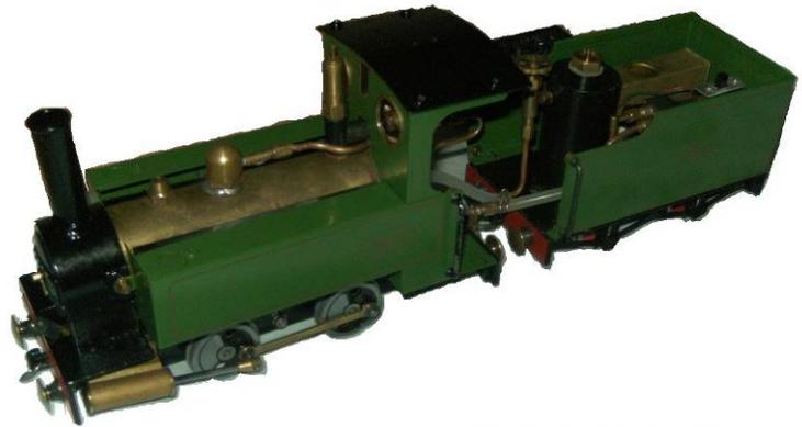
Au montage, j'ai rajouté un régulateur MAMOD et un graisseur REGNER. Les tubes sur l'inverseur sont soudés (d'origine enfiché dedans avec des joints thoriques mais peu fiable) par la suite, j'ai modifié le dôme en mettant une sortie où est branché un tube arrivant dans la cabine avec un branchement à vis pour un remplissage avec une pompe.
