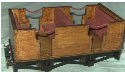
Réalisation d'une petite voiture baladeuse montée sur un châssis MAMOD acheté en kit. Les matériaux de construction sont des morceaux de cagettes récupérées et des touillettes en bois achetés chez ACTION. Rambardes en fil de cuivre 5/10 et les cordes sont en coton à tricoter.
