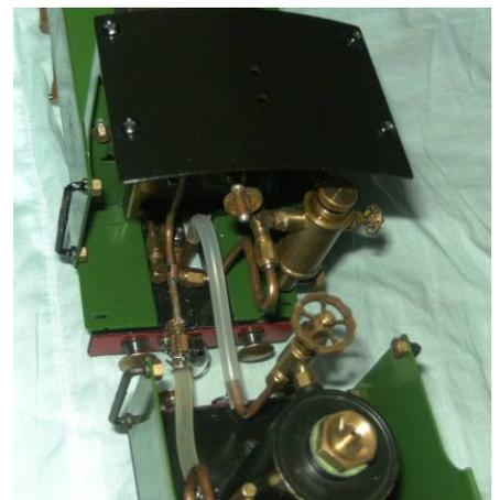
Equipement d'un tender acheté en kit avec montage de la radiocommande, d'une pompe électrique pour le remplissage sous pression, d'un réservoir de gaz REGNER pour le brûleur céramique MAMOD.
